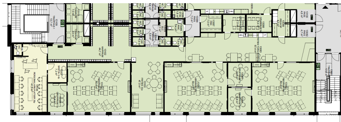
Figur 1 Ritning från Fredriksborg över hemvist (3 klassrum, torg, arbetsplatser, grupprum, toaletter, klädhängare, förråd etc)
