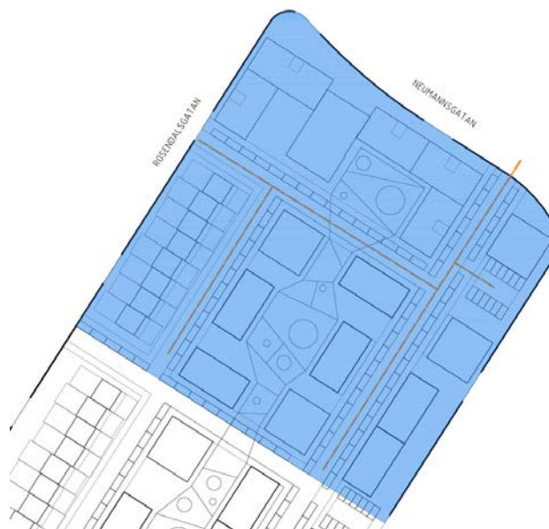
Figur 7: Översiktlig utformning av ledningsnät i den norra delen av Åkermyntan. Föreslagna ledningar i orange. Utgående ledning ansluts till befintligt system i Neumansgatan.
