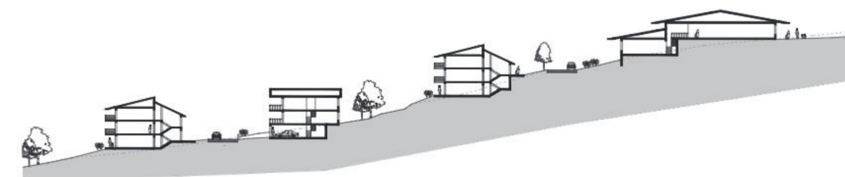
Sektion A: Längst upp till höger ligger den planerade förskolan. Därfter ses Vinkelvägen som skiljer förskolan och närmsta bostad åt. De naturliga höjdskillnaderna innebär att våningsantalet varierar som lägre mot vinkelvägen. Byggnaderna visar den maximala byggrätten på tre våningar.
