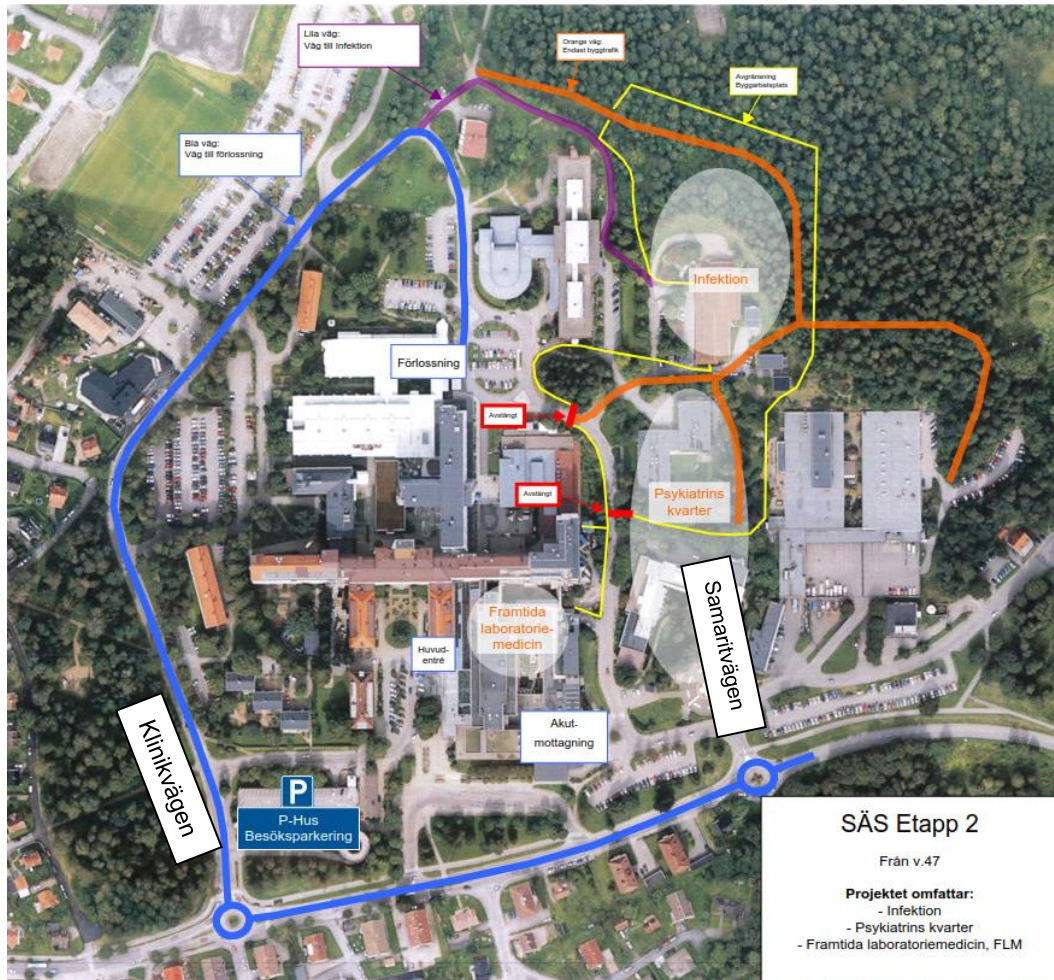
Figur 4 Trafikläggning under byggtiden vid sjukhuset. Källa: Västra Götalandsregionens hemsida
