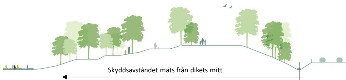
Figur 6 Illustration av hur angivet skyddsavstånd ska mätas då det finns dike.
