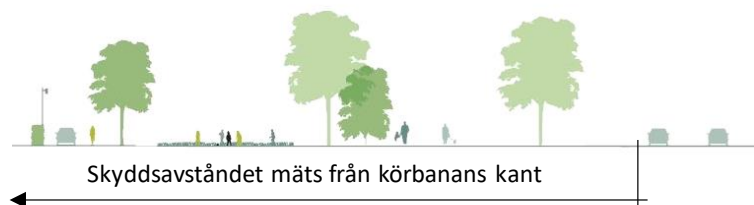
Figur 4 Illustration av hur angivet skyddsavstånd ska mätas med undantag då vall el. dyl. används. Vid järnvägstrafik gäller närmsta spårkant.
