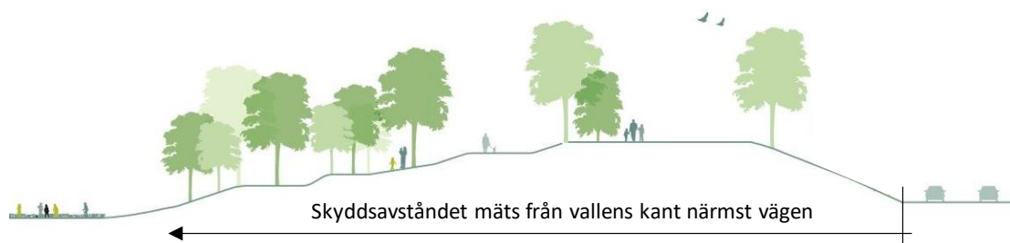
Figur 5 Illustration av hur angivet skyddsavstånd ska mätas då det finns en vall. el. dyl. mot transportleden.
