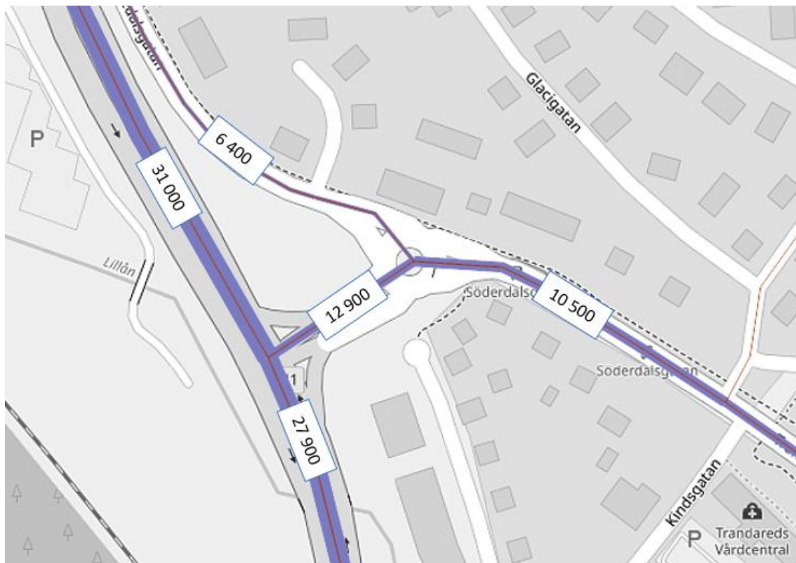
Figur 6 Beräknade vardagsdygnsflöden i anslutning till signalkorsningen väg 41-Trandaredsgatan för ett framtidsscenario år 2025, inklusive antagen exploatering för Järnhättan 5 och Svärdfästet 4.
