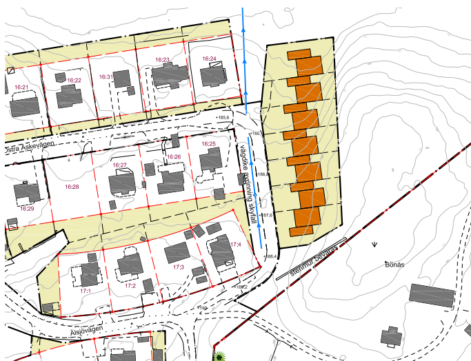
Område H vid Östra Älmevägen. Exempel på utformning vid byggnation av 7 bostäder i kedjebus.
