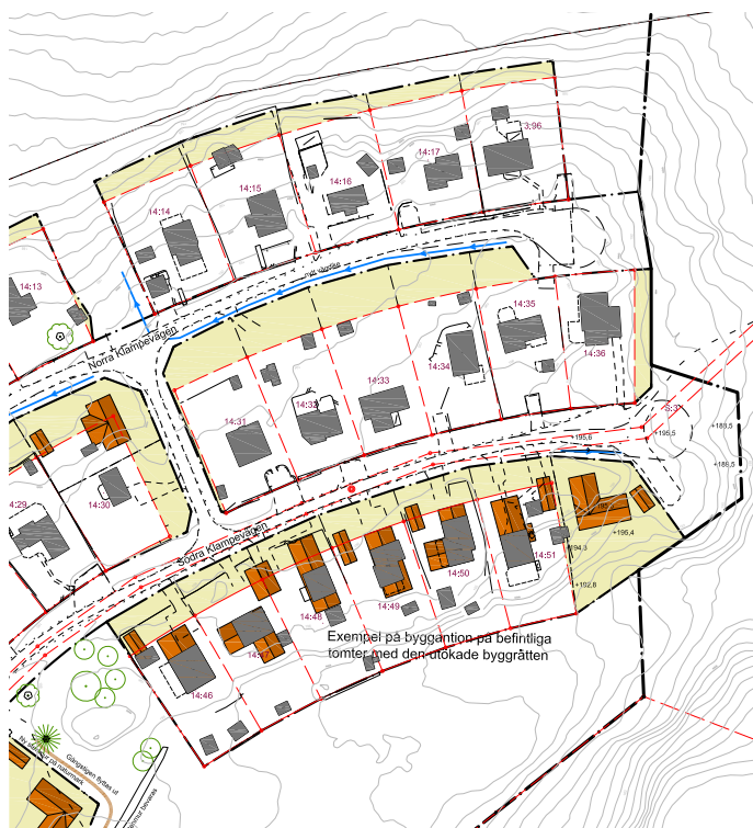
Exempel från Södra Klampevägen på nya eller tillbyggda hus enligt den utökade byggrätten.
