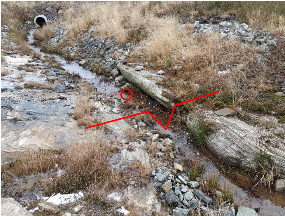
Figur 2. Plats för vattenprovtagning (röd cirkel) och flödesmätning (skisserat mätöverfall) vid Ryds mosse SV.
