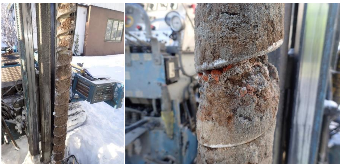
Figur 5. Till vänster syns grusiga sandiga fyllnadsmassor från provtagningspunkt 15 och till höger syns de tegelrester som påträffades i provtagningspunkt 5.
