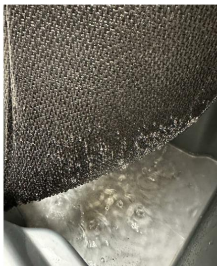
Avvattning i avvattningspåse. Separation med helt klart rejektvatten som rinner igenom.
