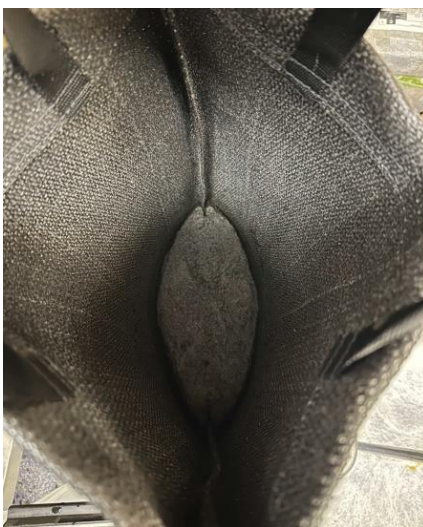
Avvattnat slam i avvattningspåsen.
