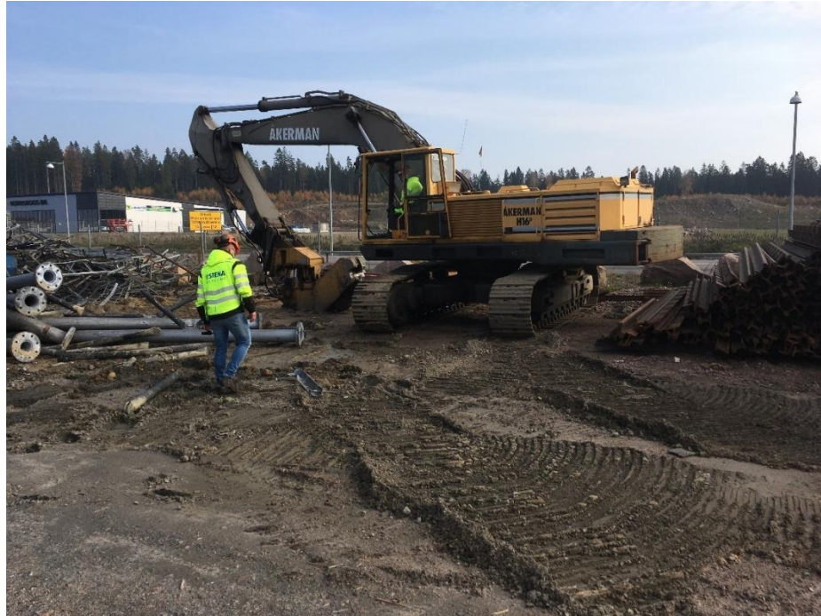
Figur 3. Materialhanterare Åkerman H16D.
