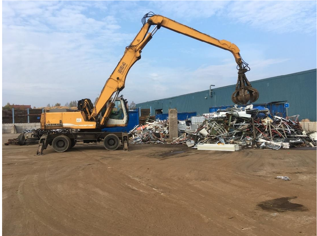
Figur 5. Materialhanterare Liebherr 924, hantering metallskrot av lägre kvalitet.
