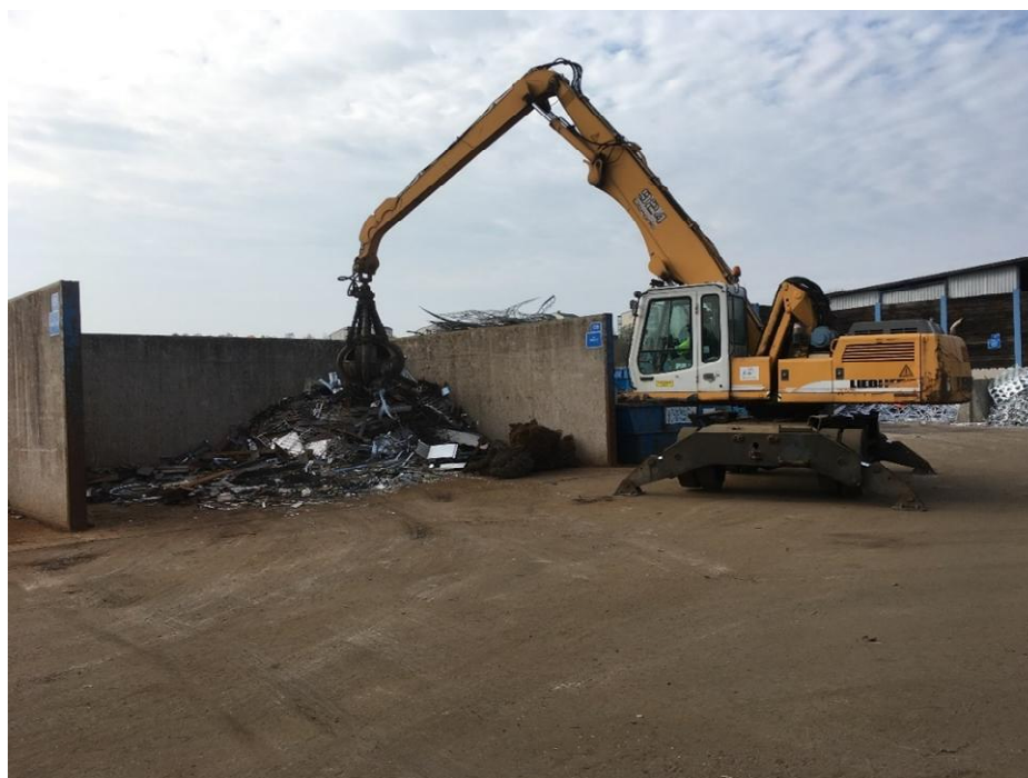
Figur 4. Materialhanterare Liebherr 924, hantering högvärdigt HDS metallskrot.
