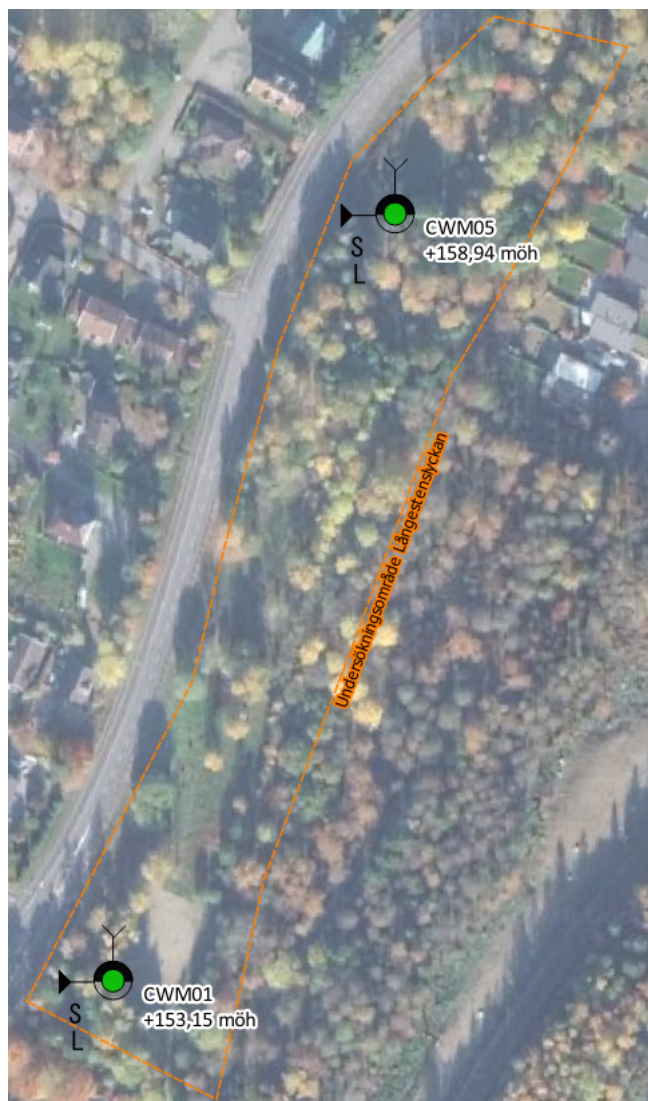
Figur 7. Torpa-Sjöbo 2:1 översiktsskarta med översiktligt resultat avseende samtliga analysparametrar i grundvatten (metaller, PAH:er, BTEX, alifater och aromater) för varje provpunkt; orange = halt > "Mycket hög halt", gul = halt > "Hög halt", grön = halt ≤ "Måttlig halt". Grundvattennivåer i meter över havet (MÖH) vid redovisas vid respektive provpunkt.
