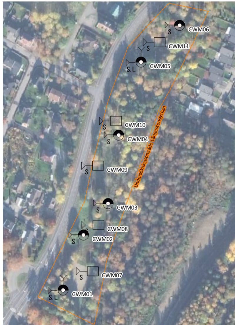
Figur 4. Provtagningspunkter Torpa-Sjöbo 2:1. Cirkeln avser plats för skruvprovtagning och installation av grundvattenrör. Fyrkanten avser plats för provgröpsgravning. Undersökningsområdet markerat med orange, streckad linje. Kartkälla Google.
